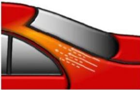
CC6500 High Performance VOC Clear oder CC6700 Ultra Performance Energy Clear gemäß Technischem Merkblatt einstellen. Den Basislack mit spritzfertig eingestelltem CC6500 High Performance VOC Clear oder CC6700 Ultra Performance Energy Clear überlackieren. Den Klarlack in abgestuften Spritzgängen mit reduziertem Spritzdruck beilackieren in den geschliffenen Bereich und bis zur Kante des polierten Bereichs.
