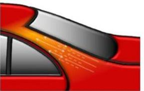
Innerhalb von 5 Minuten den puren AZ9550 High Performance Fade-Out Thinner in dünnen Spritzgängen mit reduziertem Spritzdruck (wenn eine Spritzpistole verwendet wird) in den polierten Beilackierbereich applizieren. Den Spritznebel auflösen und einen weichen Übergang herstellen. Trocknung gemäß Technischem Merkblatt des jeweiligen Klarlacks. Eine zusätzliche IR-Nachtrocknung der Beilackierzone kann das Risiko des Kantenabrisses beim Polieren reduzieren.
